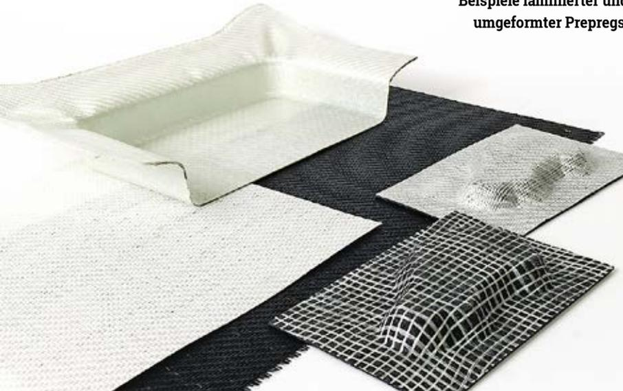
den und anschließend innerhalb kürzester Zeit umgeformt werden. Der Energieeintrag und die Aufwärmzeit sind dabei deutlich geringer als bei bekannten Composites.
